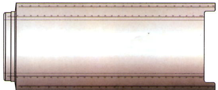
Tuyau avec armature deux NAPPES
